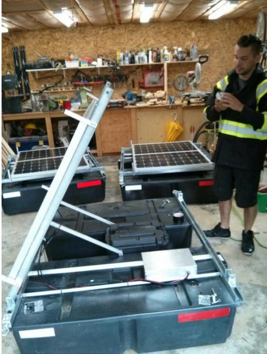
entreprises avec la compagnie Biobac (biobac.ca) afin de commander les trois appareils de type **quatro-db** de la compagnie *AlgaeControl.US LLC*. Ces appareils autonomes seront ancrés au fond du lac comme indiqué au protocole. Les appareils sont calibrés pour émettre des ultrasons à 185 décibels (dB) sur 360 degrés à une fréquence de 2 024 pulsations (période d'émission de 0,4 seconde et pause de 0,6 seconde) par cycle de 34 minutes initié aléatoirement. Le
